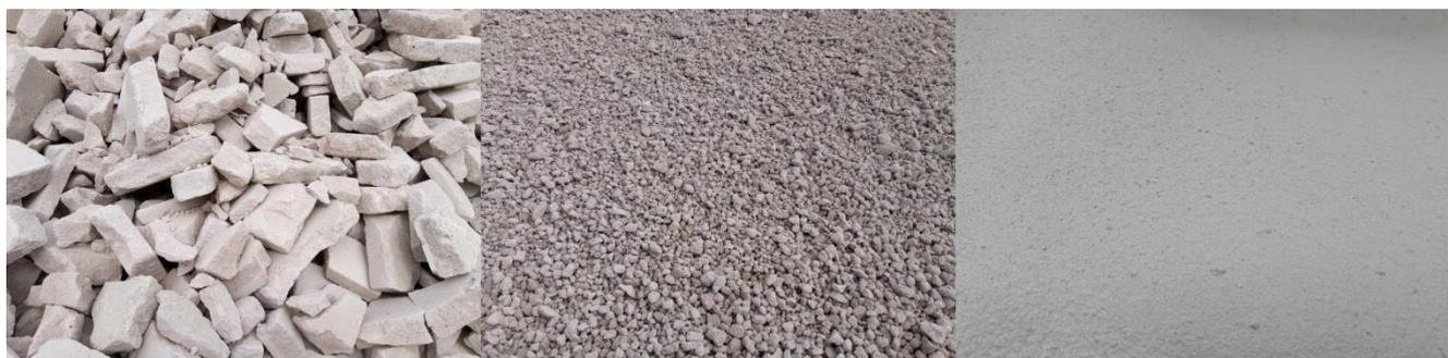
Рис. 5. Степень переработки отходов газобетонного производства (слева – колотый, в центре – дробленый, справа – молотый)
