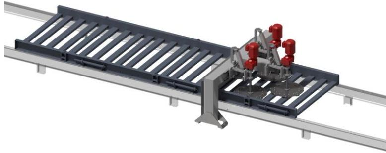
Рис. 1. Установка очистки автоклавных решеток
