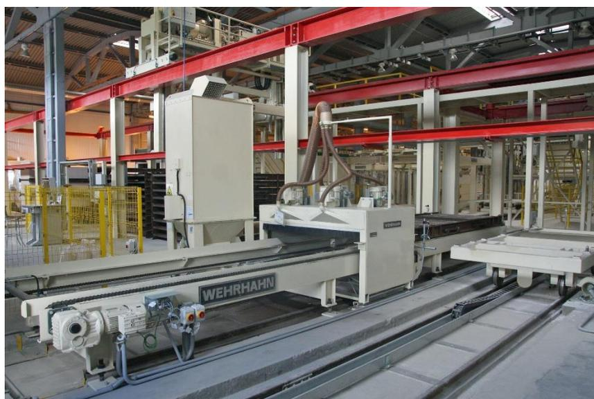
Рис. 3. Автоматическая установка чистки и смазки автоклавных решеток Wehrhahn
