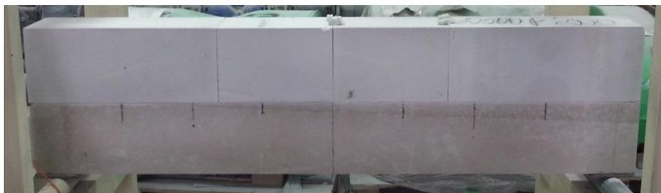
Рис. 3. Сборная составная конструкция перемычки
