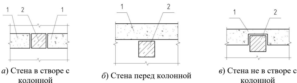
Рис. 6. Схемы расположения стен по отношению к вертикальным конструкциям несущего каркаса здания (1 - стена; 2 – колонна)
