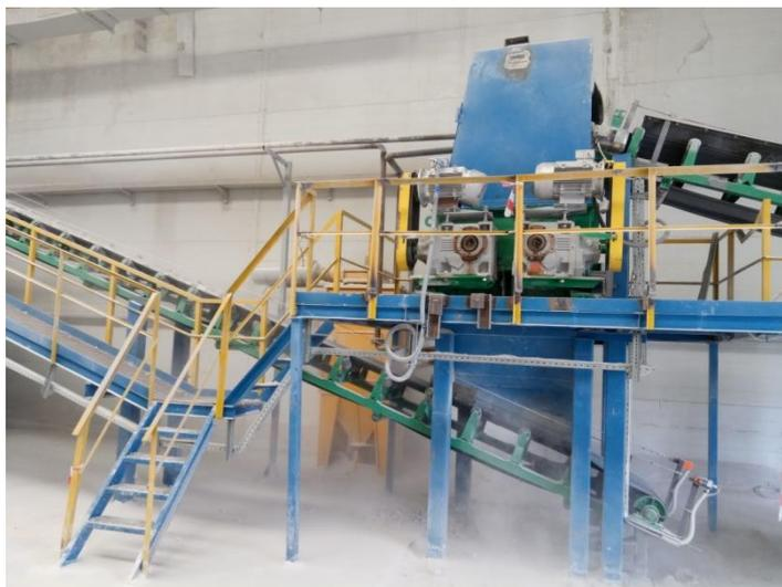
Рис. 3. Промежуточная дробилка Геркулес
