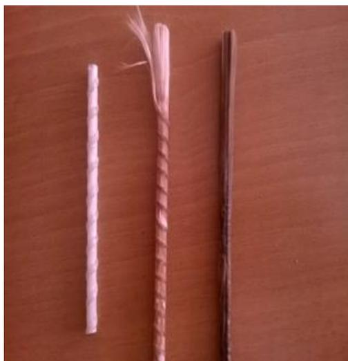
Рис. 2. Вид образцов арматуры после изъятия из ячеистого бетона, прошедшего автоклавную обработку автоклавного твердения: слева - образец на основе эпоксидной смолы и циклоалифатического амина; справа - образцы на основе эпоксидной смолы и изометилтетрагидрофталевого ангидрида
