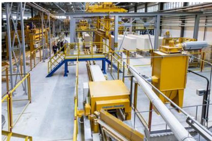
Рис. 1. Машина удаления нижнего подрезного слоя на этапе чистки запарочного днища
