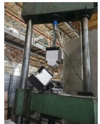
Указанный параметр кладки оказывает существенное влияние на ее прочность при действии нагрузок (ветровые и сейсмические воздействия), вызывающих изгиб стен из их плоскости.
