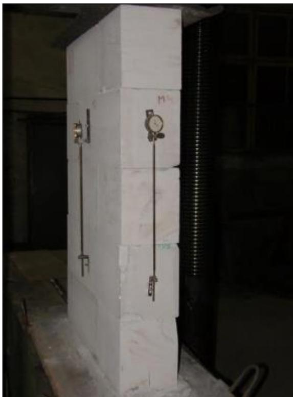
Рис. 1. Образец № 1, подготовленный к проведению испытания
