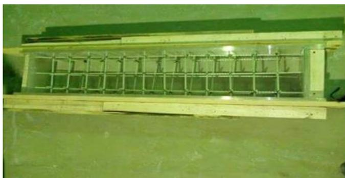
Рис. 3. Форма с каркасом из композитной арматуры
