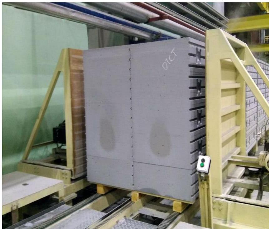
Рис. 1. «Непропар» на газобетонных изделиях
