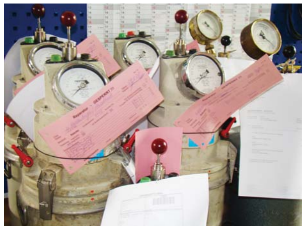
Рис. 2. Осуществление послегарантийного обслуживания и ремонта приборов определения воздухововлечения бетонной смеси на предприятии «TESTING Bluhm & Feuerherdt GmbH» в Берлине
