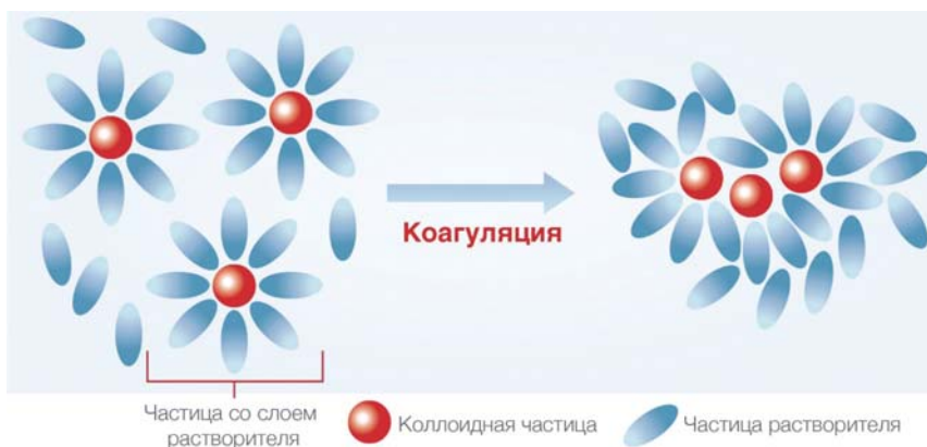
Рис. 2. Образование нежелательной коагуляции при смешивании
