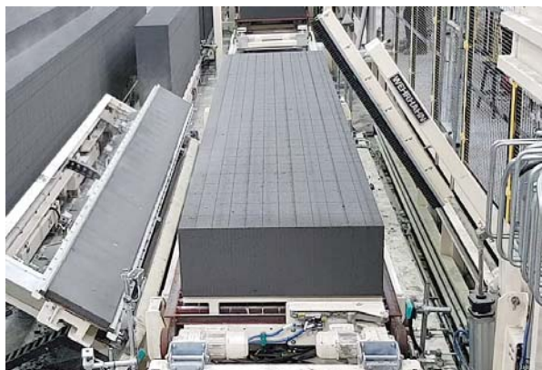
Рис. 1. Установка удаления нижнего подрезного слоя Wehrhahn
