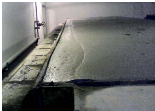
Рис. 2. Образование дефектной структуры из-за разницы температур запарочного днища и газобетонной смеси
