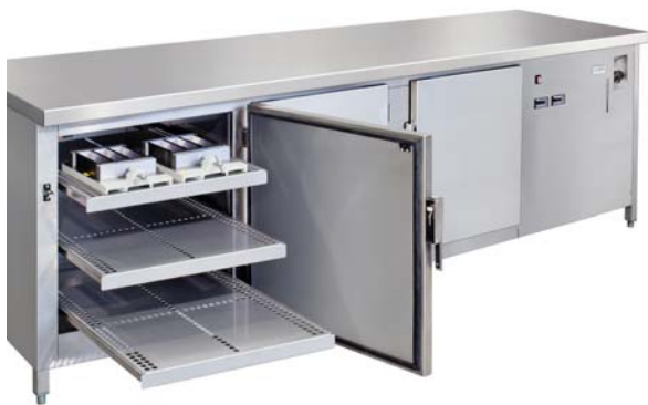
Рис. 3. Шкаф для выдержки образцов раствора в формах, выполненный в соответствии с EN 196 компанией «TESTING Bluhm&Feuerherdt GmbH»
