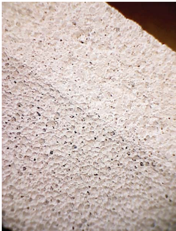
Теплоизоляционная штукатурка «ilmax thermo теплая стена 3d» (справа), нанесенная на ячеистый бетон плотностью D400, при увеличении
